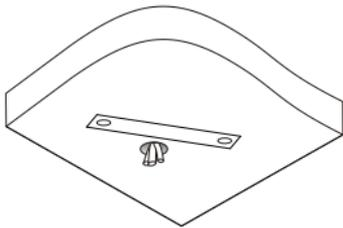
2. 천장에 구멍을 뚫으십시오.  $\varnothing 6-6.5\text{mm}$  드릴 비트를 사용하여 스티커로 표시한 위치에 따라 30mm 깊이의 가이드 구멍을 뚫습니다.
